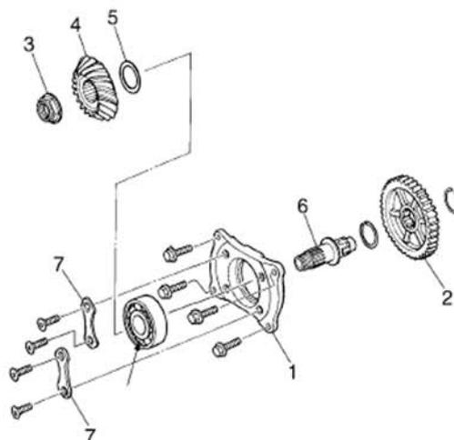
**Drive bevel gear nut**
